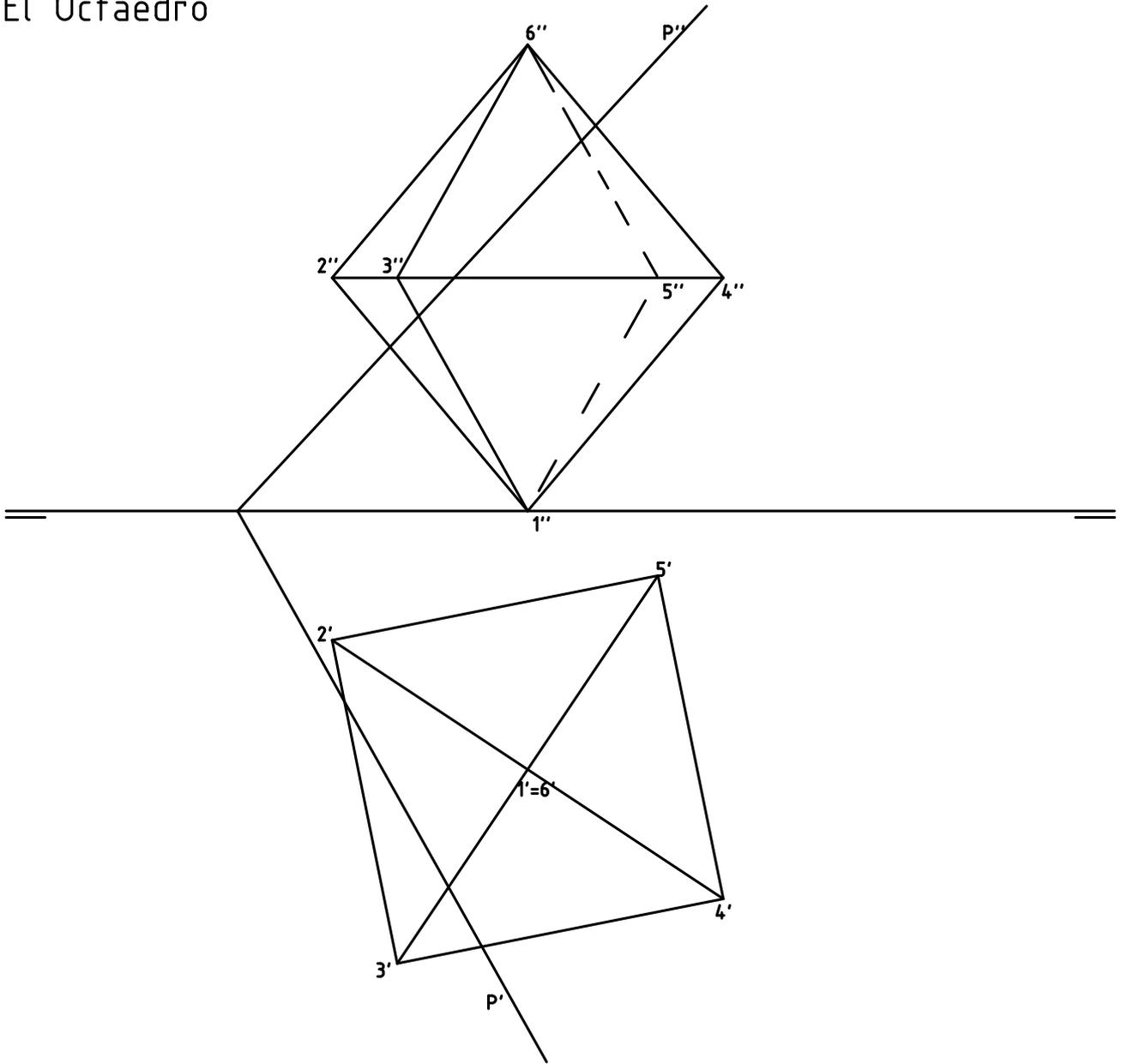
En este caso la intersección es de un plano oblicuo con un octaedro. Para ello hacemos un cambio de plano Vertical. Con ello convertimos un plano oblicuo en plano de canto colocando la LT perpendicular a P'. Como el cambio de plano vertical, mantiene la proyección horizontal y en la vertical mantiene las alturas y es la que se modifica, convierte el plano oblicuo en de canto y esta intersección sí es fácil de hacer, podemos pasar todos los puntos perpendicularmente a su arista correspondiente.
