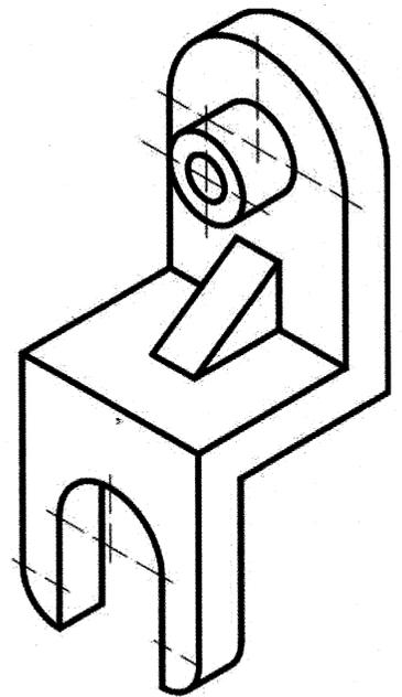
4.- Representar en perspectiva isométrica, a **escala 3:2** y sin coeficientes de reducción la pieza definida por sus vistas a escala 1:1 en el sistema del primer diedro. Tome las medidas directamente de la figura. Represente todas las líneas ocultas. (3 PUNTOS)
