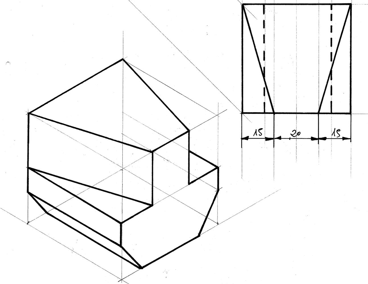
4B.- Dibujar a escala 3:2 el alzado, la planta y la vista lateral derecha del objeto dado por su perspectiva isométrica a escala 1:1 (1,8 p.). El alzado es el que se indica, tomar las medidas directamente de la figura. Realizar la acotación completa de las vistas según normas (0,9 p.). Se valorará el uso de la escala gráfica (0,3 p.) (3 PUNTOS)
