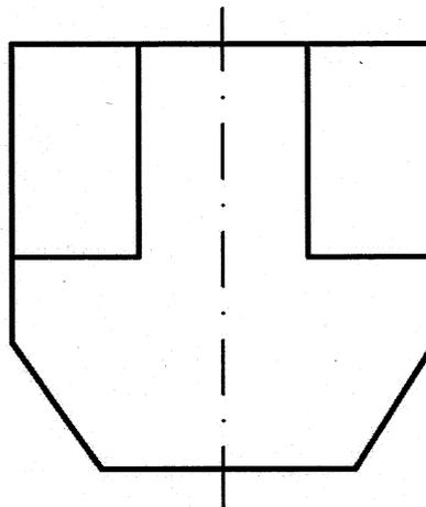
**4B.-** Dibujar a **escala 3:2** el alzado, la planta y la vista lateral derecha del objeto dado por su perspectiva isométrica a escala 1:1 (1,8 p.). El alzado es el que se indica, tomar las medidas directamente de la figura. Realizar la acotación completa de las vistas según normas (0,9 p.). Se valorará el uso de la escala gráfica (0,3 p.) (3 PUNTOS)
