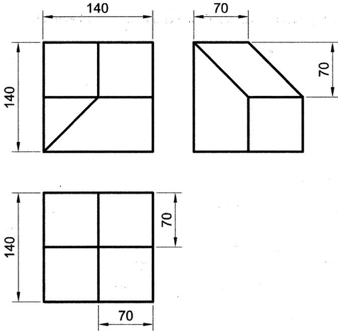
4.-Dibuje a escala 1:1 la planta, el alzado y la vista lateral izquierda del objeto dado por su perspectiva isométrica a escala 1:1 y sin coeficientes de reducción. Utilice como alzado la vista según A. Tome las medidas directamente de la figura. Realice la acotación completa de la misma según las normas.
