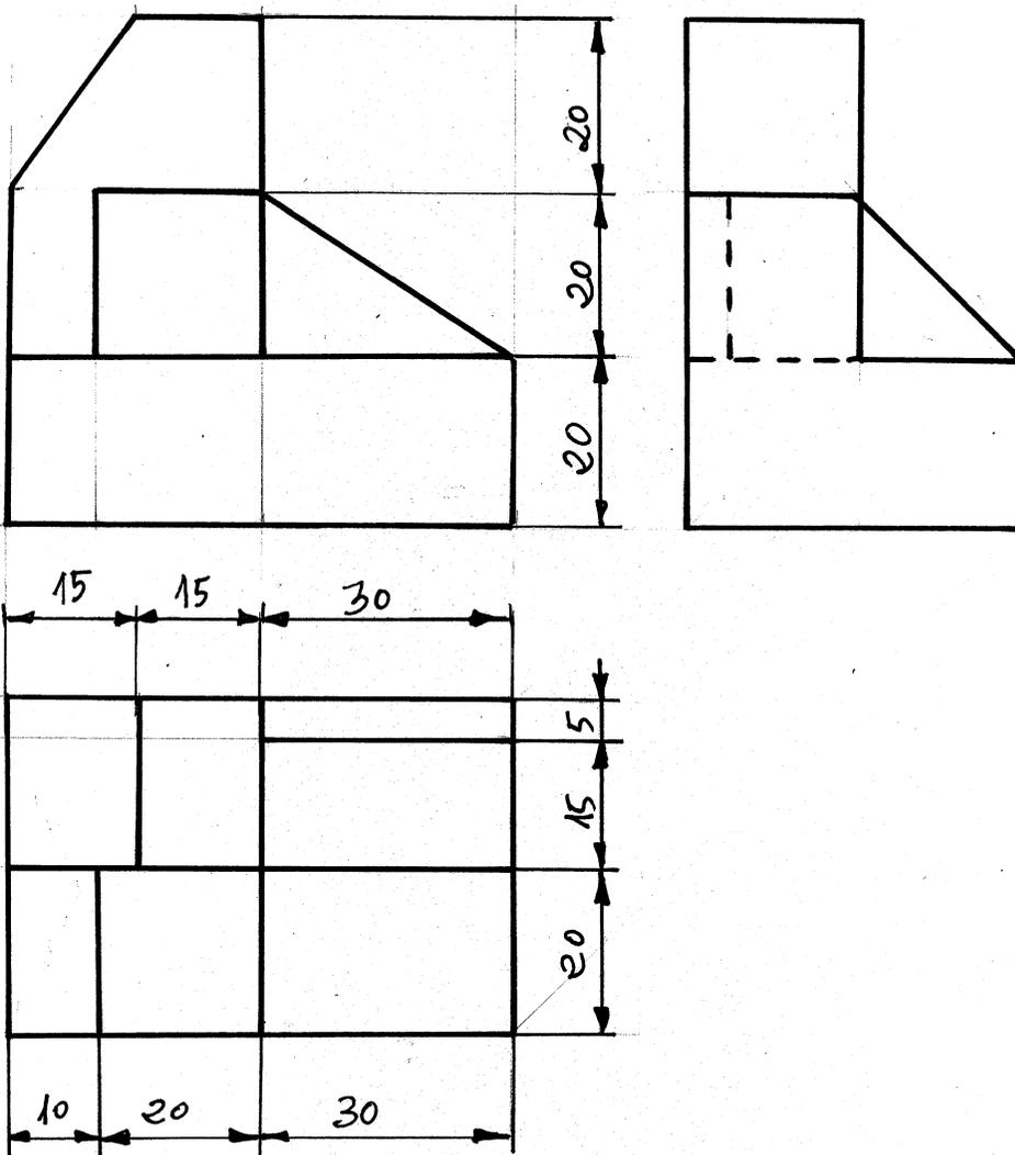
4.- Representar en perspectiva isométrica, a **escala 4:9** y sin coeficientes de reducción, la pieza definida por sus vistas en el sistema del primer diedro. Representar todas las líneas ocultas. Se valorará el uso de la escala gráfica. (3 PUNTOS)
