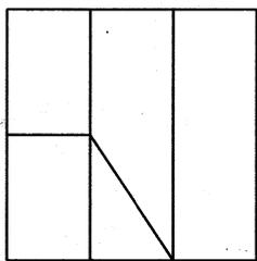
4.- Represente en perspectiva isométrica, a **escala 2:1** y sin coeficientes de reducción, la pieza definida por sus vistas a escala 1:1 en el sistema del primer diedro. Tome las medidas directamente de la figura. Represente todas las líneas ocultas. (3 PUNTOS)
