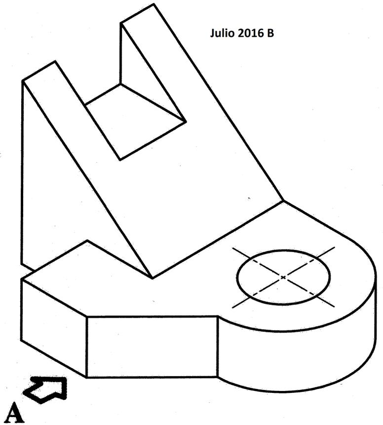
4B.- Dibuje a **escala 1:1** la planta, el alzado y la vista lateral derecha del objeto dado por su perspectiva isométrica a escala 1/1 y sin coeficientes de reducción. Utilice como alzado la vista según A. Tome las medidas directamente de la figura. Realice la acotación completa de la misma según normas. Se valorará el uso de la escala gráfica.
