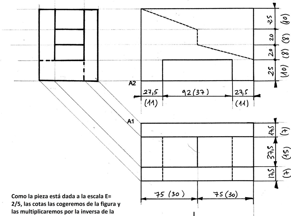
Como la pieza está dada a la escala  $E=2/5$ , las cotas las cogemos de la figura y las multiplicaremos por la inversa de la escala a la que nos la dan, o sea  $5/2$ . Entre paréntesis está la medida en mm de lo que mide el dibujo dado en diédrico, que son las medidas de la escala  $2/5$ . Las cotas, que están sobre la línea de cota y sin paréntesis, son siempre números reales, por ello al número entre paréntesis se le multiplica por la inversa de la escala.
