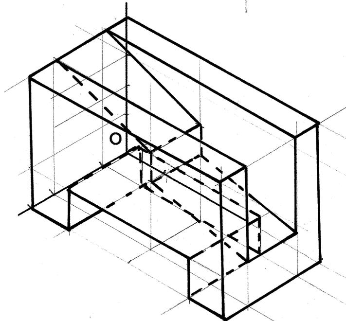
4B.- Dibuje a **escala 4:3** la planta, el alzado y la vista lateral derecha del objeto dado por su perspectiva isométrica a escala 1:1 y sin coeficientes de reducción. Utilice como alzado la vista según A. Tome las medidas directamente de la figura. Realice la acotación completa de la misma según normas. Se valorará el uso de la escala gráfica. (3 PUNTOS)
