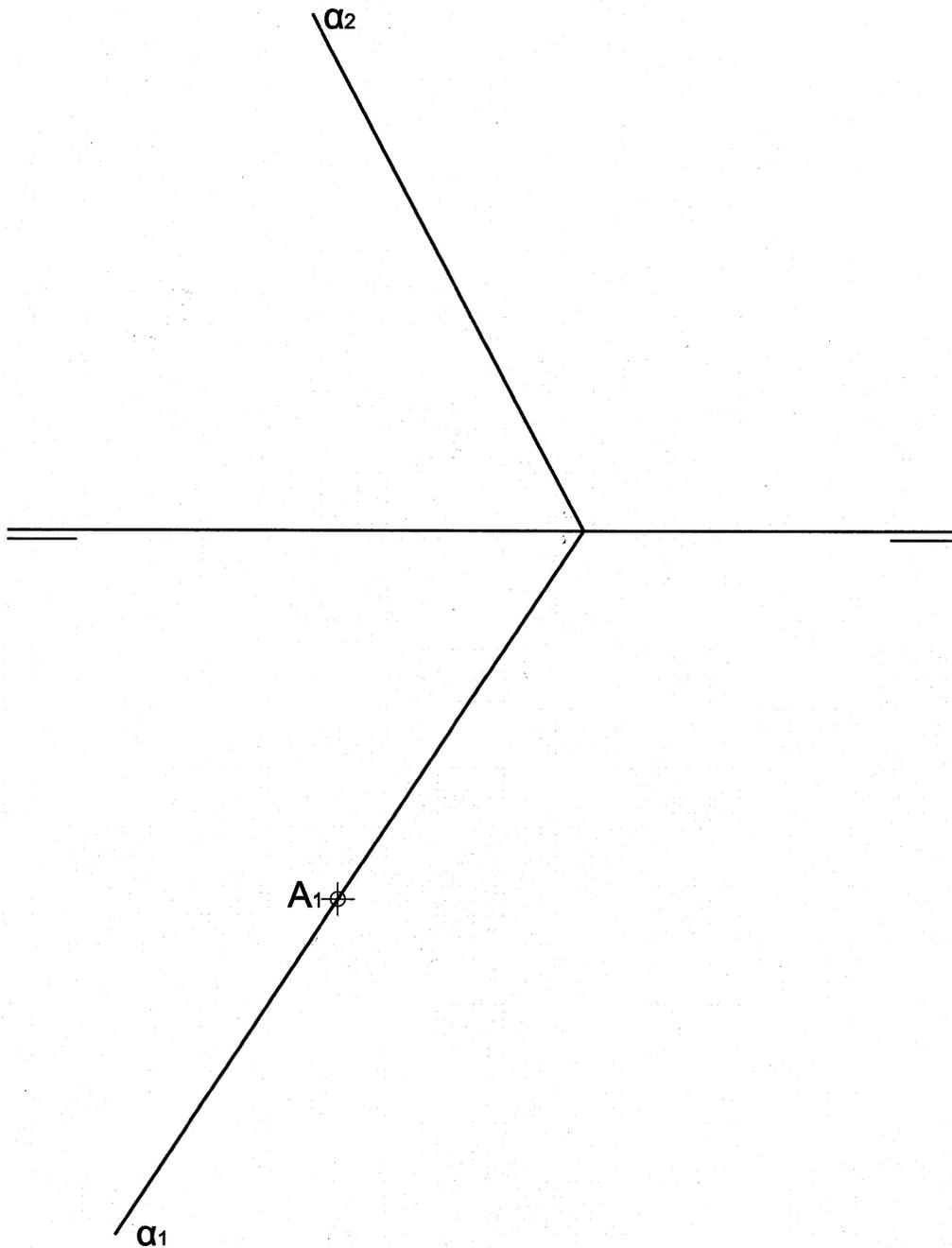
**3B.-** Dado el punto A, la proyección horizontal de un punto B y la traza horizontal del plano  $\alpha$ , se pide obtener las proyecciones del triángulo ABC sabiendo que está contenido en el plano  $\alpha$ , que la altura del lado AB son 30 mm y que el ángulo opuesto (C) son  $60^\circ$ . Elegir la solución de menor cota (3 PUNTOS) Junio 2018 B
