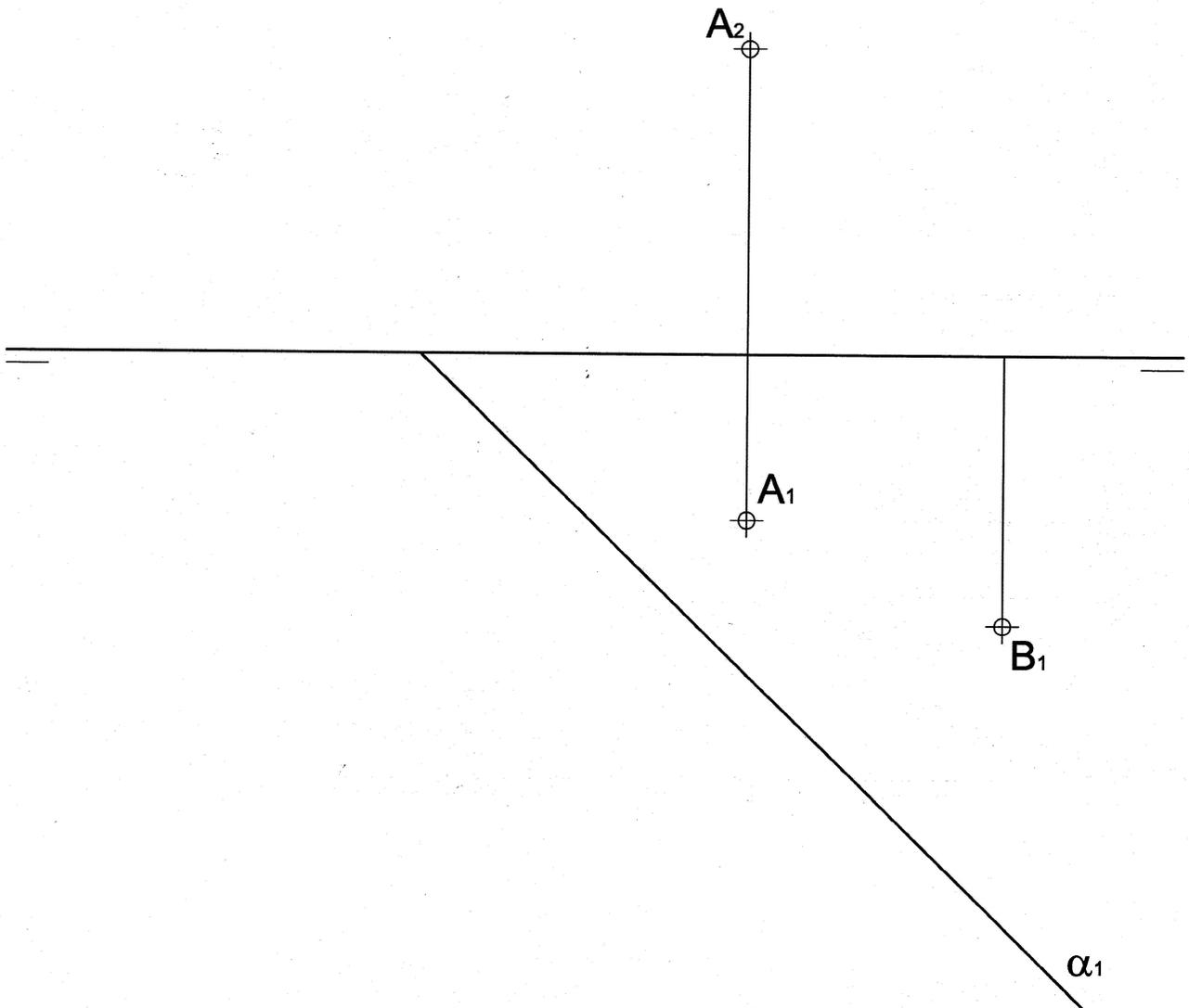
**3B.-** Dado el punto A, la proyección horizontal de un punto B y la traza horizontal del plano  $\alpha$ , se pide obtener las proyecciones del triángulo ABC sabiendo que está contenido en el plano  $\alpha$ , que la altura del lado AB son 30 mm y que el ángulo opuesto (C) son  $60^\circ$ . Elegir la solución de menor cota (3 PUNTOS)
