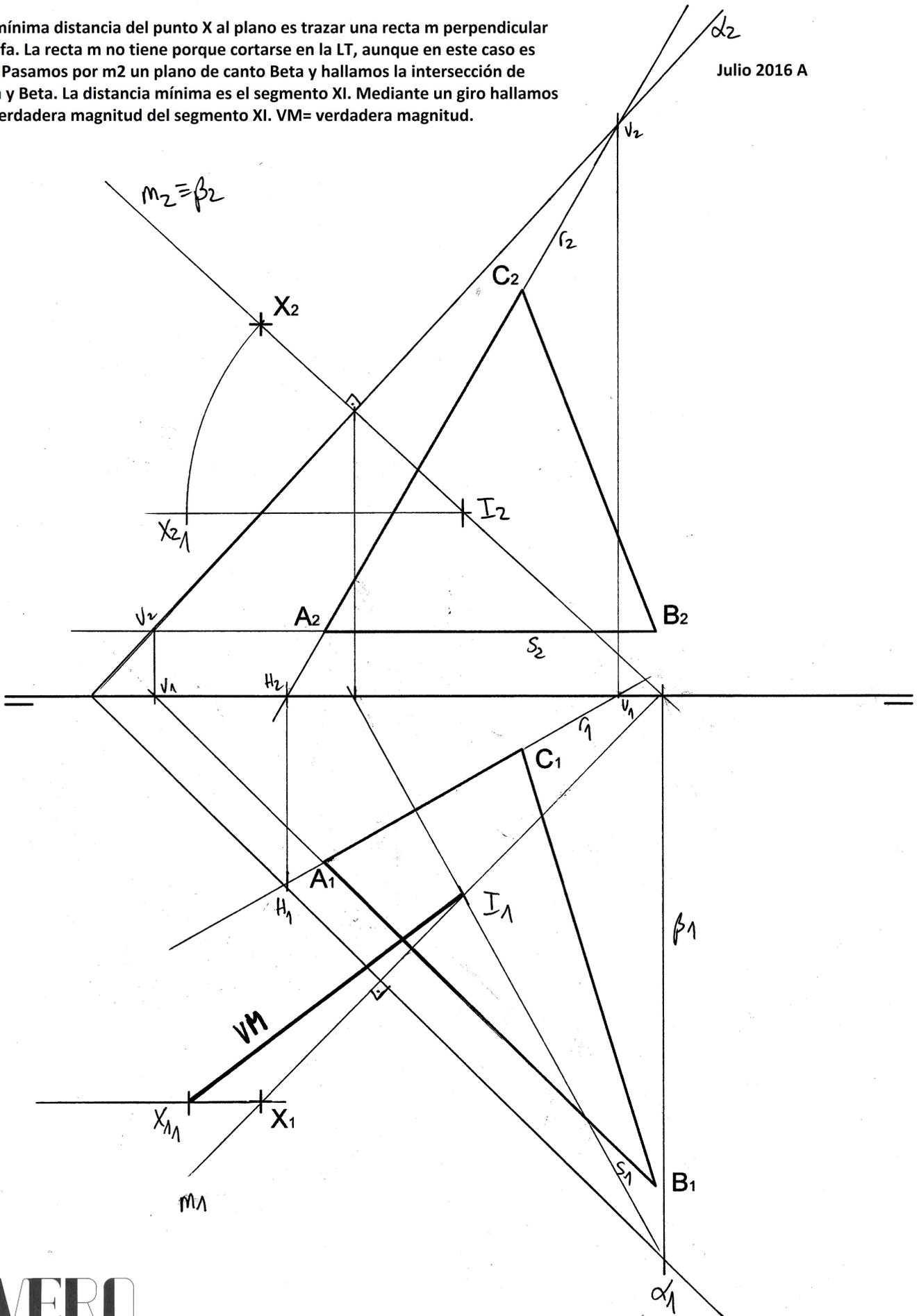
3B.- En la figura se representa la recta r, el punto X, y la proyección horizontal de una pirámide regular apoyada en el plano horizontal de proyección, de base triangular ABC y 70 mm de altura. Determine las trazas del plano  $\alpha$  definido por la recta r y el punto X. Obtenga la proyección vertical de la pirámide. Represente la sección que el plano  $\alpha$  produce en la pirámide, tanto en proyecciones como en verdadera magnitud.
