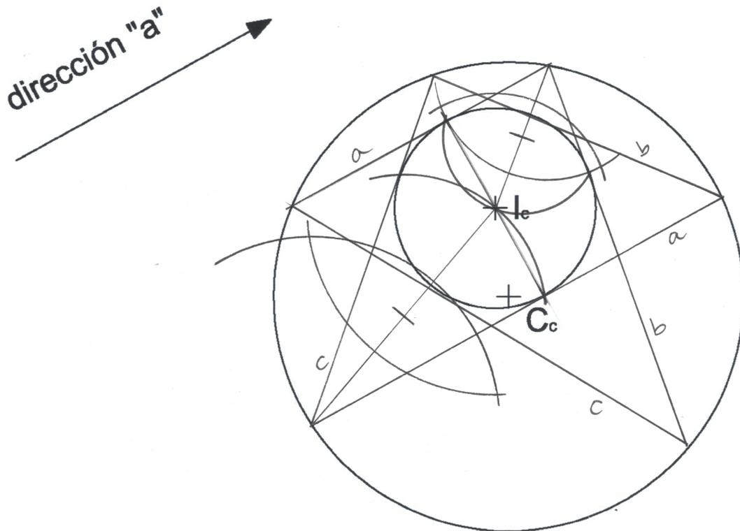
**3B.-** Dado el punto A, la proyección horizontal de un punto B y la traza horizontal del plano  $\alpha$ , se pide obtener las proyecciones del triángulo ABC sabiendo que está contenido en el plano  $\alpha$ , que la altura del lado AB son 30 mm y que el ángulo opuesto (C) son  $60^\circ$ . Elegir la solución de menor cota (3 PUNTOS)
