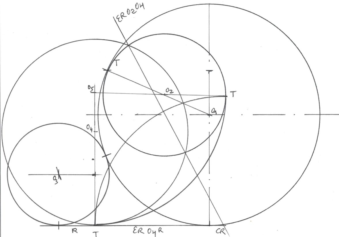
2B.- Dados el incentro, el circuncentro y sus correspondientes circunferencias, de un triángulo ABC. Dibujarlo conociendo la dirección del lado  $a$ . Dibujar todas las soluciones posibles (2 PUNTOS)
